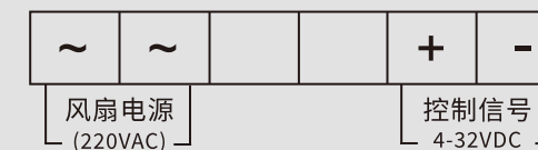
接线端子排和控制板接线示意图
